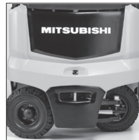
Sterowność tylnej osi w pełnym zakresie 100°
